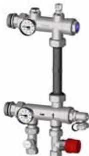
Il gruppo di miscelazione **art.3497**, è adatto per essere impiegato in impianti per la distribuzione di acqua a bassa temperatura ai pannelli radianti. Il gruppo è previsto per l'allacciamento delle tubazioni di mandata e ritorno a caldaie con circolatore incorporato.
