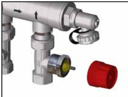
Avvitare il comando termostatico sulla valvola (filetto M30x1.5)
